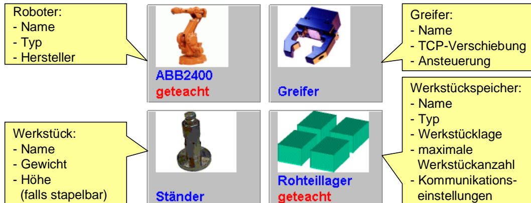
Bild 2: Erforderliche Daten für die Modellierung von Roboterzellen
