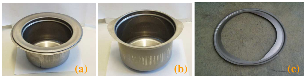
Abbildung 2: Topf (a) vor dem Arbeitsgang "Rand beschneiden" und (b) danach. In (c) ist der abgeschnittene Rand zu sehen (WMF).
